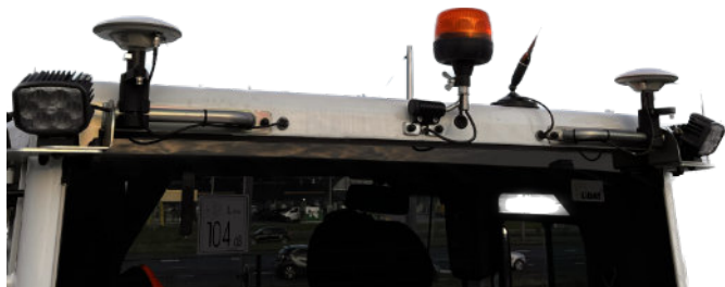
De GPS-antennes zijn snel en veilig op en af te bouwen.
