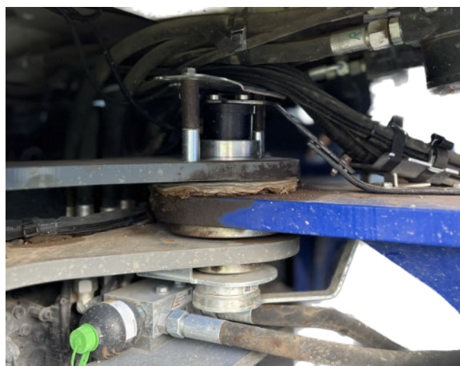
Een contactvrije sensor op de knik zorgt voor snelle, accurate hoekmeting.
